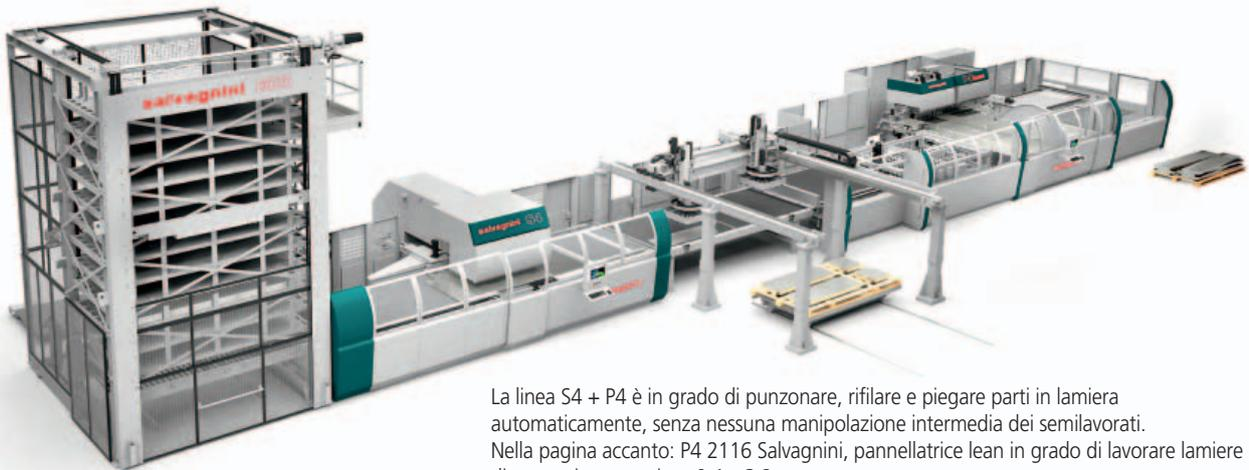
La linea S4 + P4 è in grado di punzonare, rifilare e piegare parti in lamiera automaticamente, senza nessuna manipolazione intermedia dei semilavorati. Nella pagina accanto: P4 2116 Salvagnini, pannellatrice lean in grado di lavorare lamiere di spessori compresi tra 0,4 e 3,2 mm.
